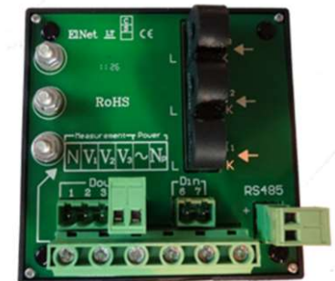
Compteur énergie électrique (Wattmètre) Mesure de l'intensité électrique via des tores ou transformateurs d'intensité
